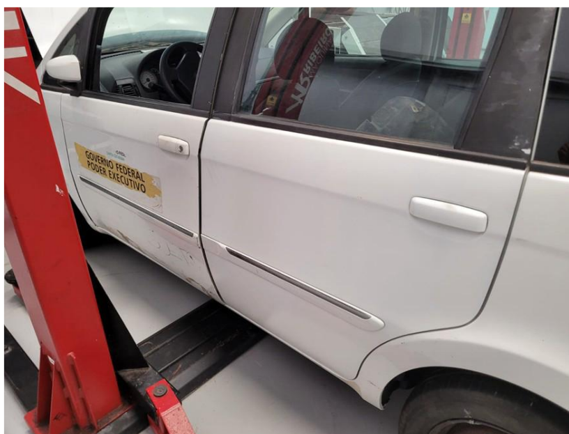
Figura 1 – Atividades de funilaria. Porta traseira (à dir.) sob cuidados dos alunos e porta dianteira (à esq.) sem intervenção
