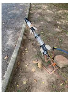
Figura 1 – Foguete de garrafa PET com dois estágios
