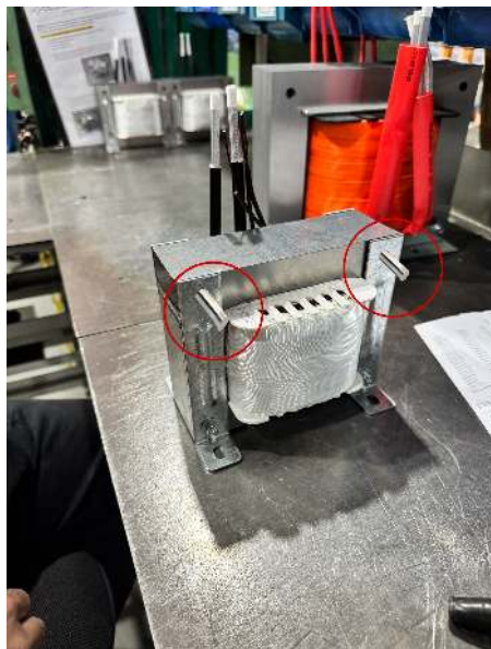
Figura 3 – Sugestão de Poka-Yoke para um dispositivo de alinhamento das Patilhas.
