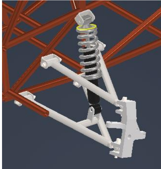
Figura 4: Modelo 3D do conjunto de Bandejas projetados
