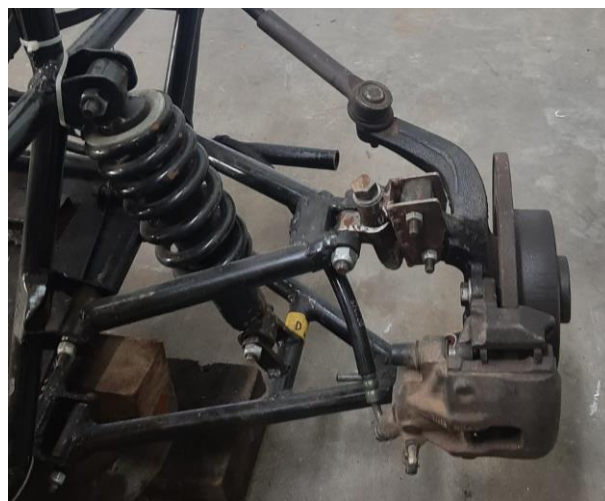
Figura 3: Conjunto de Bandejas em Duplo A e Manga de eixo e terminal de direção utilizado na versão anterior do protótipo.
