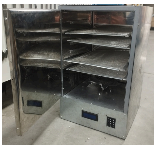
Figura 1 - montagem final do secador (a) e edição de receitas por rede (b)
