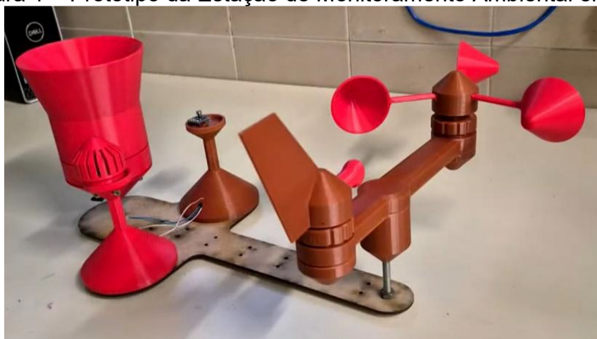
Figura 1 – Protótipo da Estação de Monitoramento Ambiental em 3D
