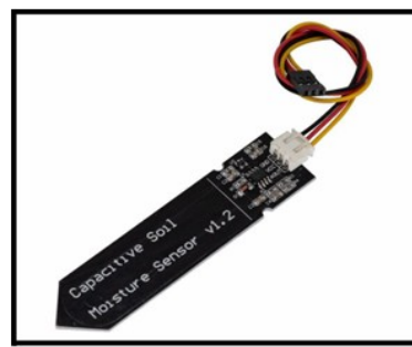
Figura 1 - Sensor de umidade e temperatura DHT11 , Figura 2 - Módulo sensor de luminosidade com LDR e Figura 3 - Sensor Capacitivo de umidade do solo
