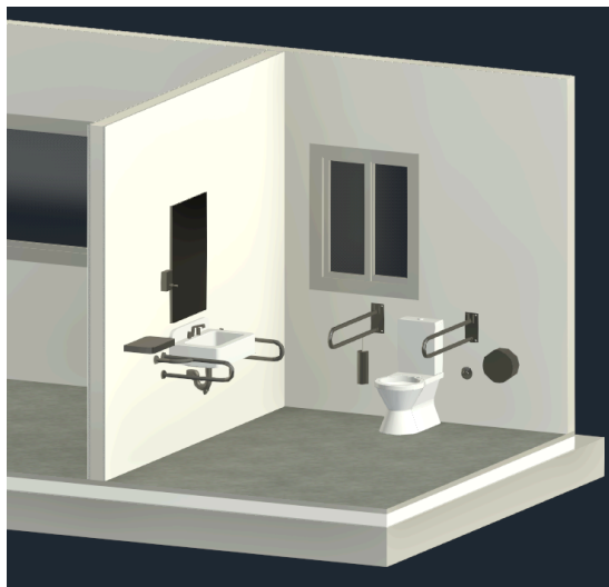
Figura 7 – Perspectiva do banheiro conforme norma de acessibilidade
