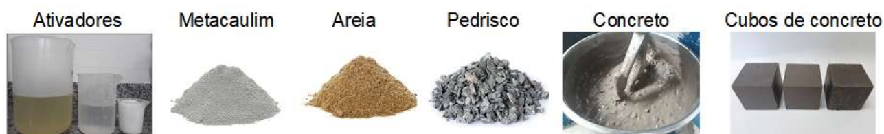
Figura 1 – Materiais, mistura e cubos geopolimérico.
