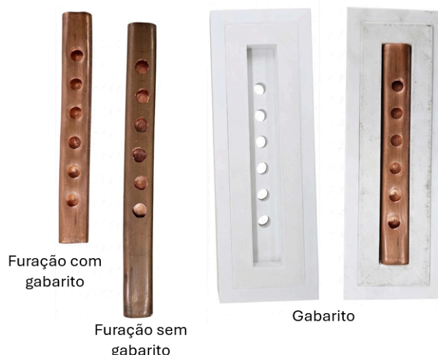
Figura 3 - Comparação de tubos \frac{3}{4} após conformação e furação, com gabarito e sem gabarito.
