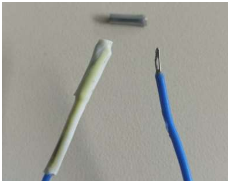
Figura 4 - Tubo de metal, sensores com e sem poço térmico
