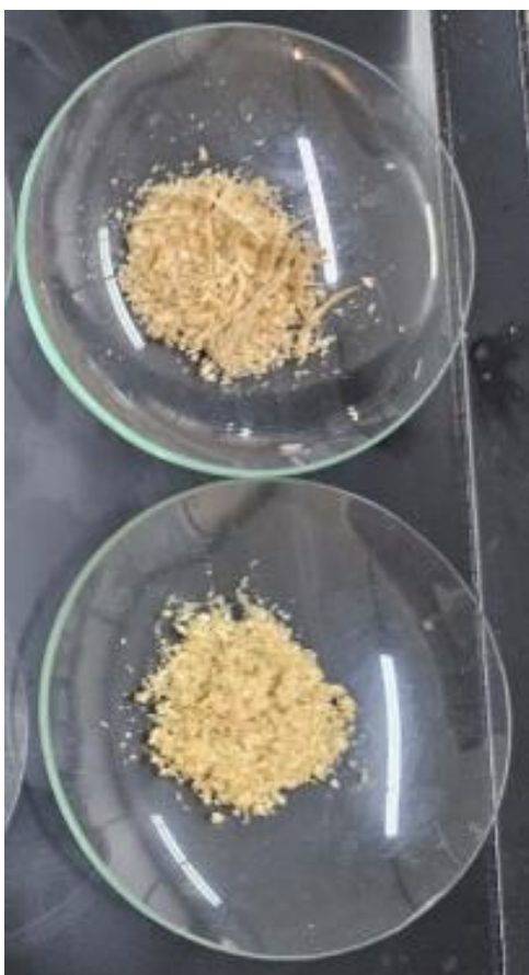
Figura 1 – Resíduo madeireiro antes (acima) e após o processo de deslignificação e branqueamento (abaixo).
