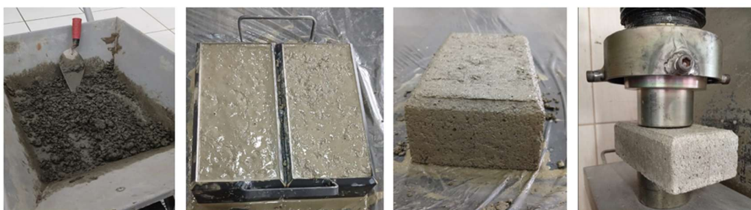
Figura 1 - Mistura, moldagem e teste de resistência à compressão.
