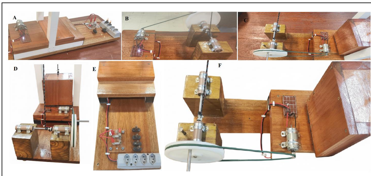
Figura 1 – Componentes técnicos do protótipo: (A) vista superior da base; (B) motor-gerador CC com LED aceso; (C) rolamentos, polia e correia; (D) polia motriz e sistema de transmissão; (E) painel elétrico; (F) vista superior da cadeia de transmissão completa.
