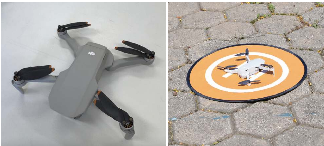
Figura 1 - Drone DJI Mini 4K utilizado na captura de imagens das fachadas
