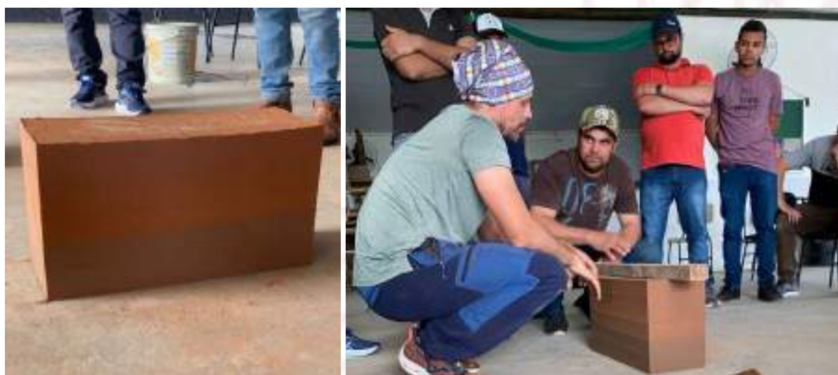
Figura 1 - Parede em taipa de pilão confeccionada em Campos Novos - SC.
