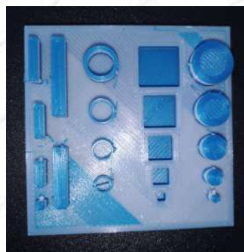
Figura 2b - Impressão de teste de junções
