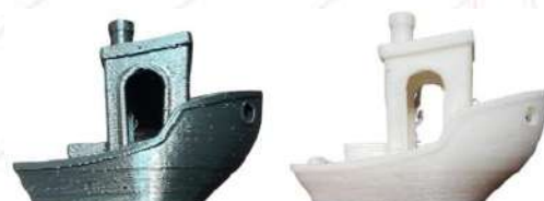
Figura 5 - Comparação de peças com filamento comercial (preto) e filamento da extrusora (branco)
