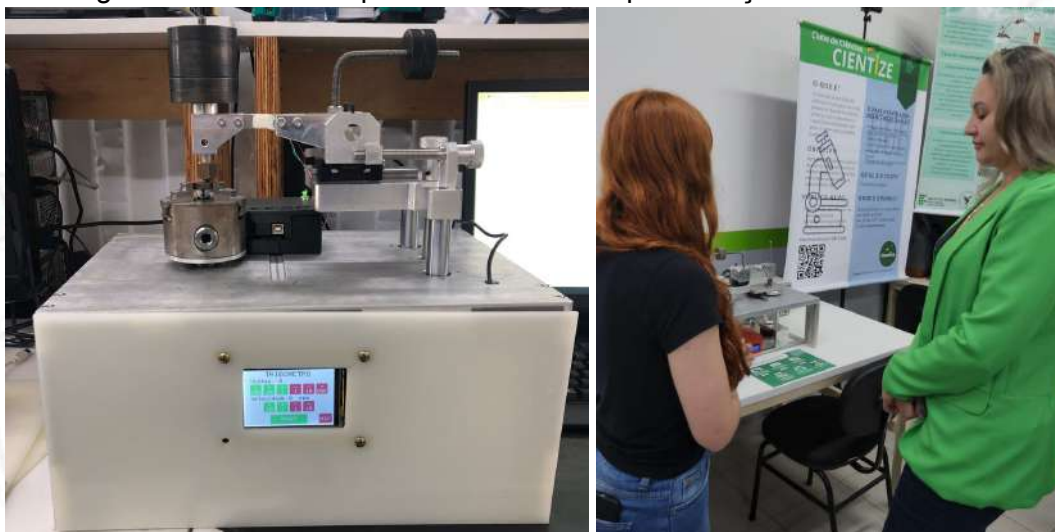
Figura 1 – Tribômetro pino-sobre-disco e apresentação na SNCT 2023.
