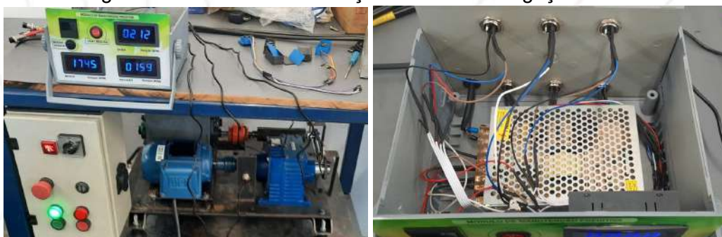
Figura 3 – Painel com as rotações e corrente / ligação elétrica
