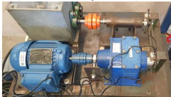
Figura 1 – Sensores de rotação instalados na bancada
