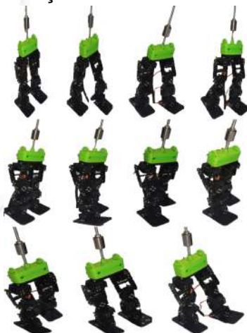
Figura 5 – Posições de marcha do robô bípede..
