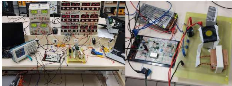
Figura 2 – (a) Versão do Protótipo do Boost com a Protoboard de Controle e Fonte Auxiliar de 24 V (esquerda); e (b) Registro dos Ensaio Práticos em Laboratório do Protótipo do Boost com Controle eM Malha Fechada (direita)
