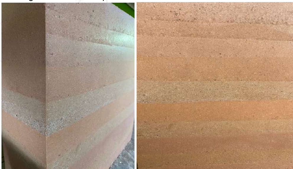
Figura 1 – Paredes experimentais com os solos salmão e amarelo.
