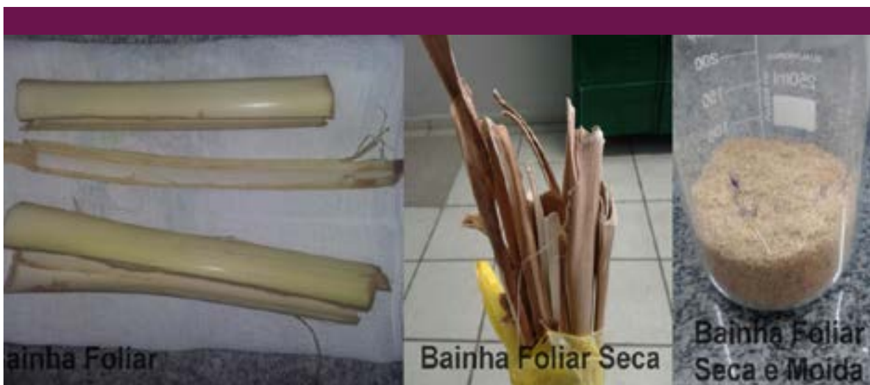
Figura 2. Etapas do processo de secagem e moagem da bainha foliar, sendo em sequência: bainha foliar, bainha foliar seca e bainha foliar seca e moída.
