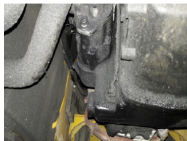
4.b) Vazamento do filtro de transmissão
