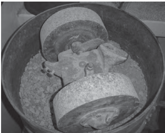
Figura 1 – Detalhe do moinho de rolos empregado para a obtenção do agregado de reciclagem de cerâmica vermelha.
