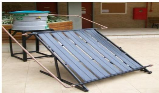
Neste trabalho foi feito uso de uma placa coletora como da figura acima – com dimensões de 1m x 1,5m, a qual possui capacidade de elevar a temperatura de 100 litros de água entre 10°C e 15°C na maioria dos dias de céu limpo e com a presença de sol – para avaliar a eficiência no aquecimento da água e a economia monetária que pode ser obtida com a utilização do aquecedor solar de baixo custo na cidade de Araranguá.
