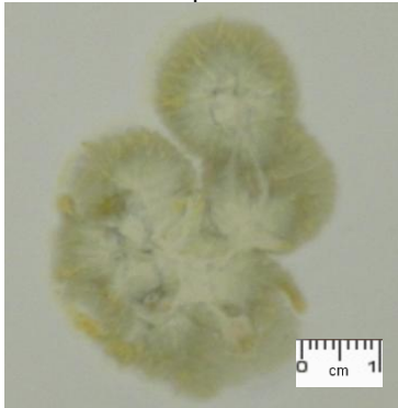
Figura 10 – Efeito do esmalte 1 sobre um esmalte de monoporosa extremamente fundente.
