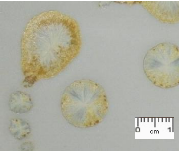
Figura 10 – Efeito do esmalte 1 sobre um esmalte de monoporosa extremamente fundente.
