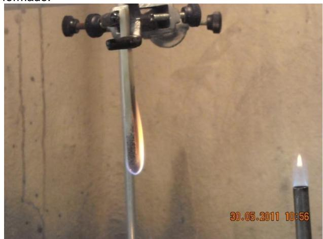
Os resultados obtidos demonstram que hidróxidos de magnésio e alumínio podem ser utilizados como retardantes de chama juntamente com fibra de vidro. Quando se compara a retardância de chama em corpos de prova somente com hidróxidos e corpos de prova com hidróxidos e fibra de vidro, percebe-se uma maior retardância à chama. Contudo, ainda não se atinge a classificação V0, ou seja, composto polimérico que não goteja e extingue a chama.
