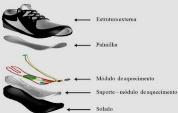
Figura 7: Vista explodida da montagem do produto
